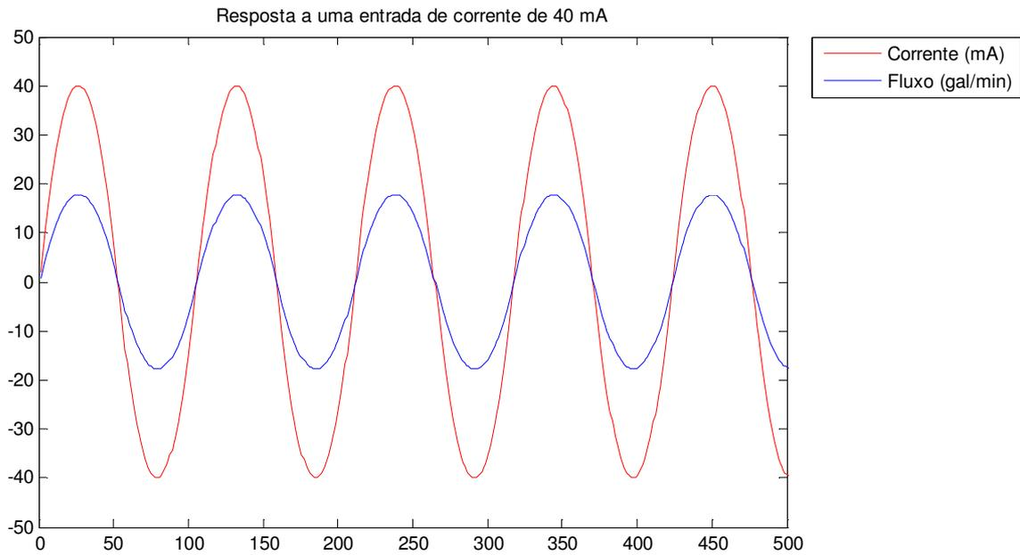
Figura 4.4. Fluxo gerado pela servo-válvula para uma entrada de corrente de  $\pm 40$  mA.
