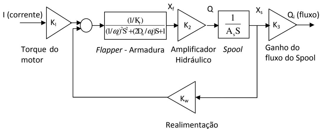
Figura 4.2. Diagrama de Blocos da servo-válvula de realimentação mecânica [moog].
