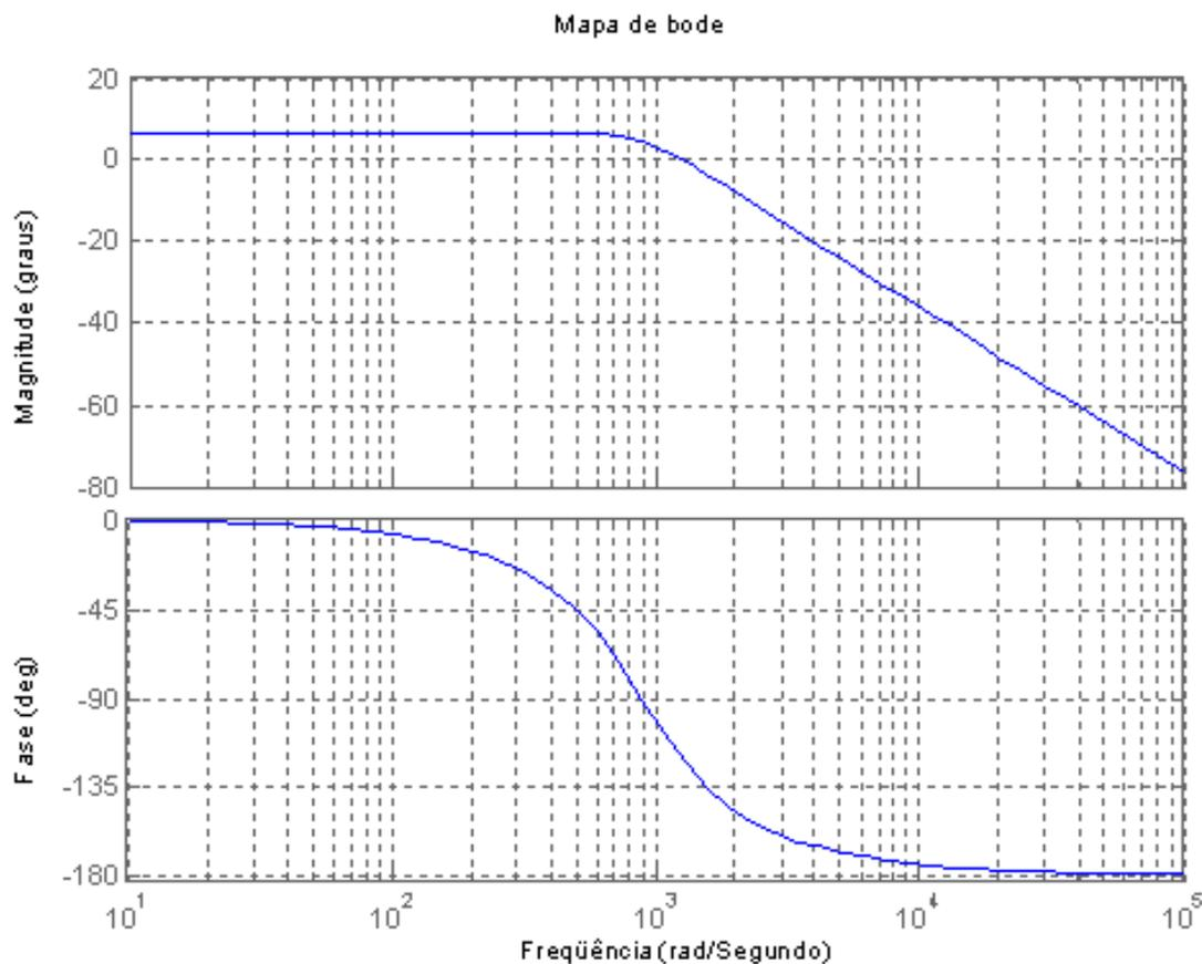
Figura 4.5. Diagrama de Bode da função de transferência da servo-válvula hidráulica.
