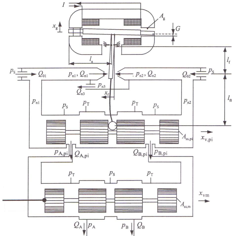
Figura 4.1 Representação esquemática da servo-válvula de três estados.
