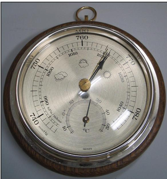
Figura 3 – Ilustração do barômetro aneróide usado no presente trabalho.
