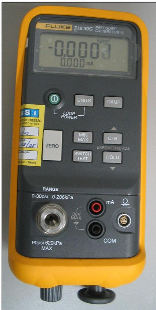
Figura 2 – Ilustração do Manômetro Fluke Modelo 718 30G.
