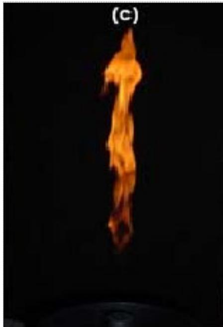
**Figura 1.2** Fotografia do queimador tipo obstáculo operando em regime turbulento de combustão com número de Reynolds do GNV de 7235. [4]
