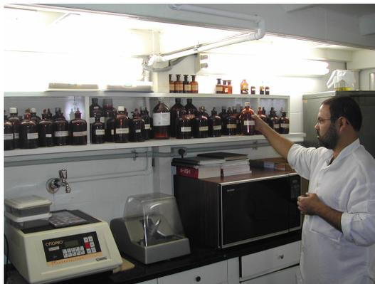
Figura 53. Histotécnico escolhendo reagentes e corantes para realização das técnicas histoquímicas necessárias à coloração dos tecidos. Notam-se prateleiras com reagentes sob a qual encontramos balança eletrônica, afiador automático de navalha de micrótomo, forno de microondas e a direita, uma estufa. Os frascos com substâncias químicas como o ácido sulfúrico, ácido nítrico podem causar queimaduras.
