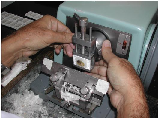
Figura 27. Detalhe do ajuste do bloco no aparelho. Nota-se a posição da mão próxima a navalha de metal do aparelho. Percebe-se, ainda, o artifício que o histotécnico usou cobrindo as extremidades da navalha com esparadrapo na tentativa de minimizar acidentes.
