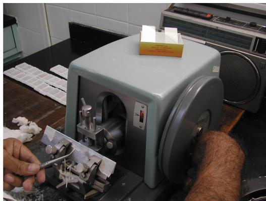
Figura 30. O processo de microtomia sendo realizado. A mão direita do histotécnico faz girar a manivela enquanto que a esquerda segura uma pinça que
