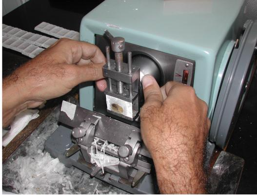
Figura 26. O bloco de parafina é, então, colocado no micrótomo, onde se realiza a microtomia. O histotécnico regula o aparelho para ajustar a posição e inclinação do bloco em relação à navalha e iniciar a microtomia. São cortados em média 100 blocos por dia durante aproximadamente 5 horas de trabalho dedicadas a microtomia.
