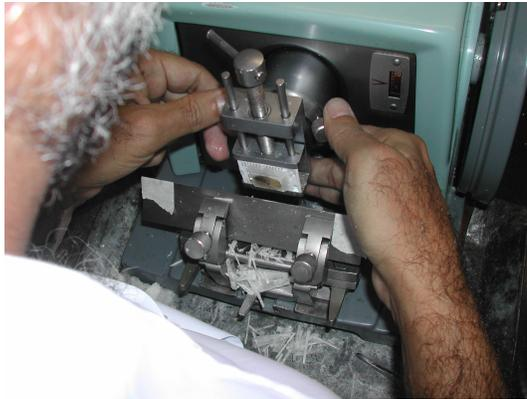
Figura 28. Um outro ângulo do detalhe do ajuste do bloco ao micrótomo.
