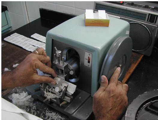
Figura 29. O processo de microtomia sendo realizado, mostrando a mão direita fazendo girar a manivela do aparelho, a qual eleva e abaixa o bloco em relação à navalha. A mão esquerda, em contacto com a navalha segura a fita de parafina cortada do bloco.
