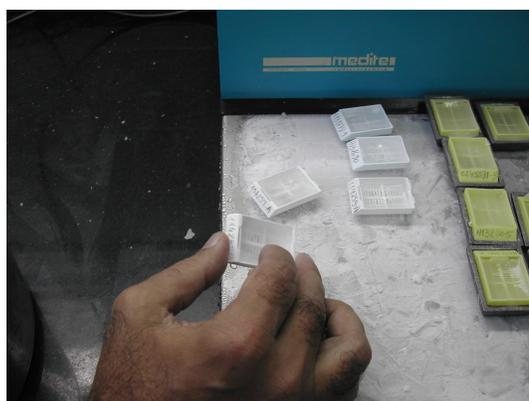
Figura 25: Bloco preparado para ser colocado no micrótomo.
