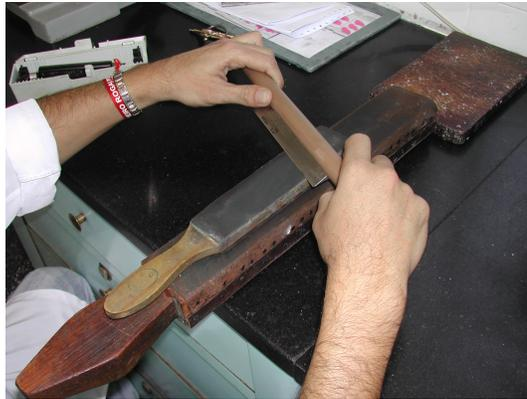
Figura 52. O histotécnico afiando manualmente a navalha do micrótomo. Esta é encaixada numa bainha para permitir que se realize o movimento de vai e vem sobre o cepo coberto de couro. Nesta atividade também há risco de acidentes com corte de mãos e dedos com a navalha.
