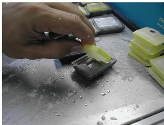
Figura 24. O conjunto, molde de metal, cassete de plástico e material parafinado, que foi recoberto com parafina aquecida e líquida, é levado ao setor de refrigeração do aparelho auto-inclusor. Dessa maneira, a parafina que recobre o cassete torna-se endurecida e se destaca do molde de metal, como visto na foto, formando-se o bloco de parafina, no meio do qual se encontra o material a ser examinado. O bloco está formado e pronto para ser submetido à microtomia.
