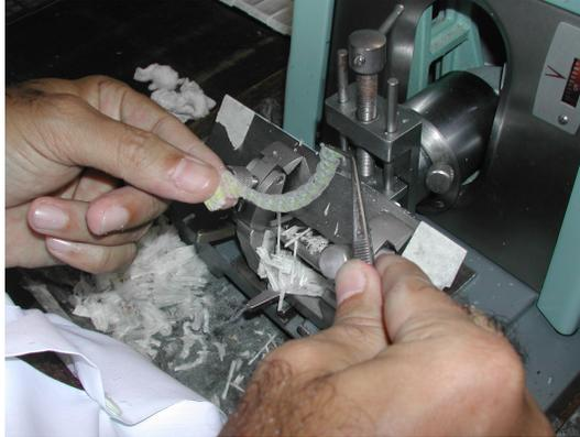
Figura 31. A manipulação do técnico para retirar a fita de parafina obtida no processo de microtomia do bloco. A mão direita segura a pinça que suavemente desfaz a aderência com a navalha. A mão esquerda segura a ponta da fita, auxiliando o processo.
