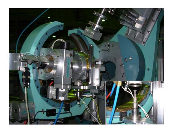
Figura 25 - Difratômetro incorporado com câmara de alta temperatura para testes *in situ* - LNLS
