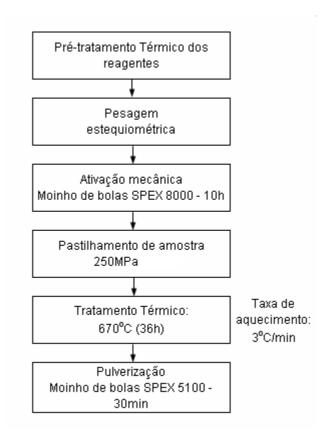
Figura 24 – Diagrama de fluxo do processo de síntese das soluções sólidas.
