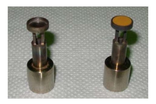
Figura 26 – Porta-amostra de aço 310 utilizado na difração de Raios-X a alta temperatura – LNLS.
