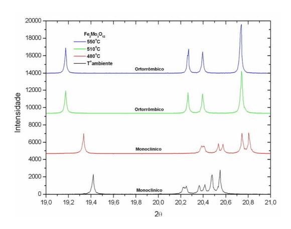
Figura 27 - Difratogramas registrando a transição da estrutura monoclínica (Temp. ambiente) para ortorrômbica ( $512^{\circ}$ C) do Fe<sub>2</sub>Mo<sub>3</sub>O<sub>12</sub> ( $\lambda$ =1,3777Å).
