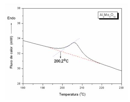
Figura 28 – Cálculo da temperatura de transição de fase para o  $Al_2Mo_3O_{12}\,$  a partir da curva DSC.
