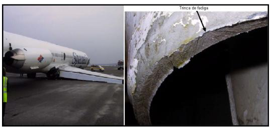
Figura 1.3 - Falha por fadiga no trem de aterrissagem de um avião. (Reporte de acidente de avião No: EW/C2001/5/1).
