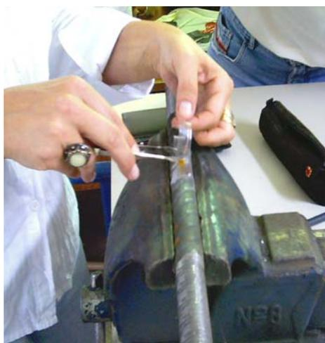
(c) fixação do "strain-gauge" na barra
