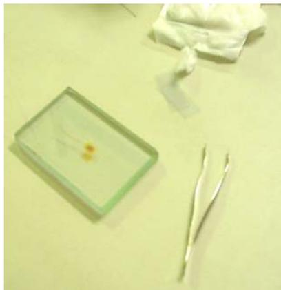
(b) "strain-gauge" sobre placa de vidro limpa
