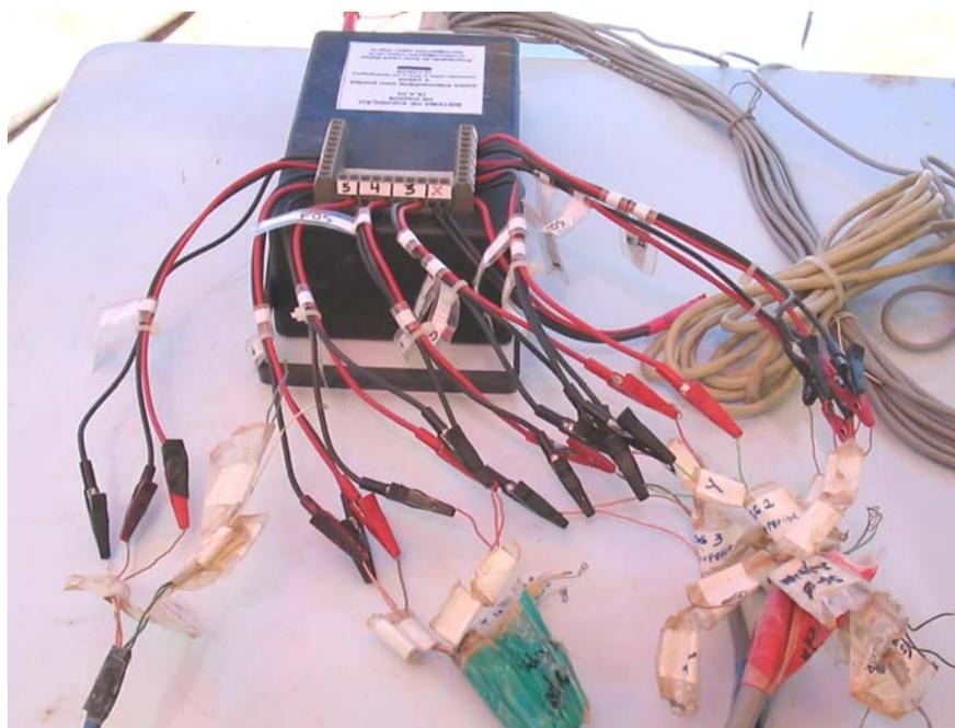
(a) caixa que contém as placas de aquisição e detalhe das ligações por conectores
