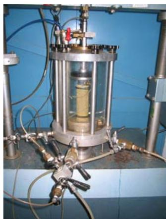
(a) detalhe da câmara triaxial
