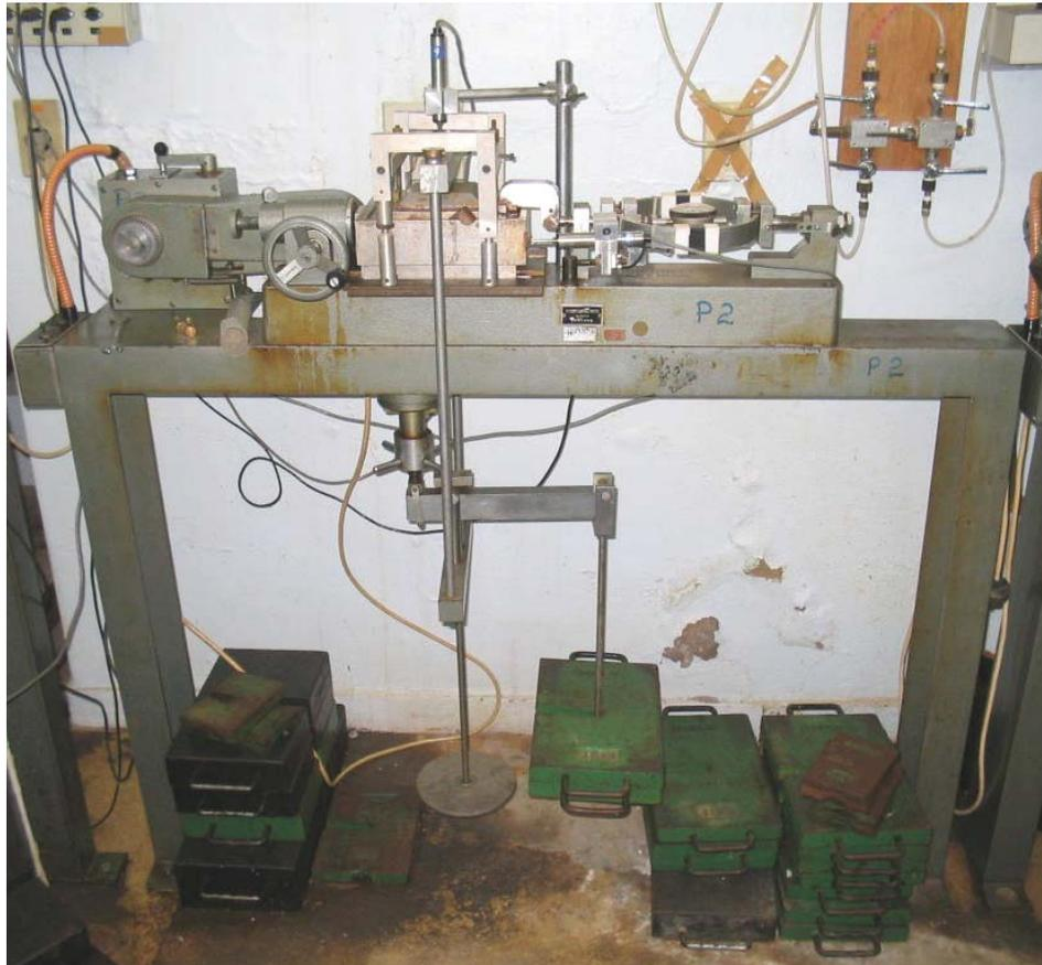
Figura 113. Prensa de deformação controlada utilizada pelo laboratório de geotecnia da PUC-Rio.
