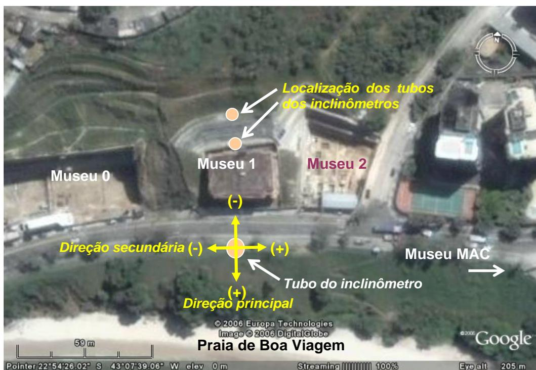
Figura 133. Localização e orientação dos tubos de inclinômetros instalados.
