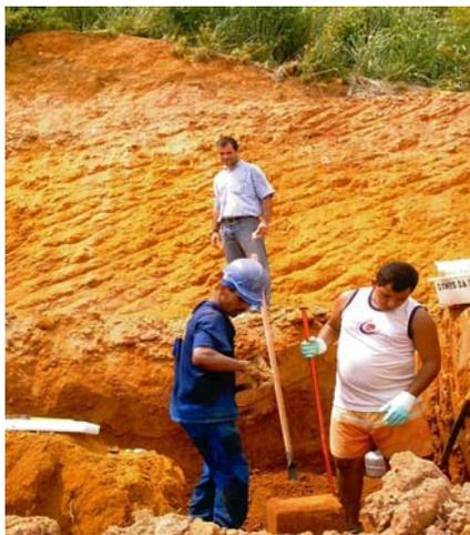
(a) Coleta de bloco indeformado
