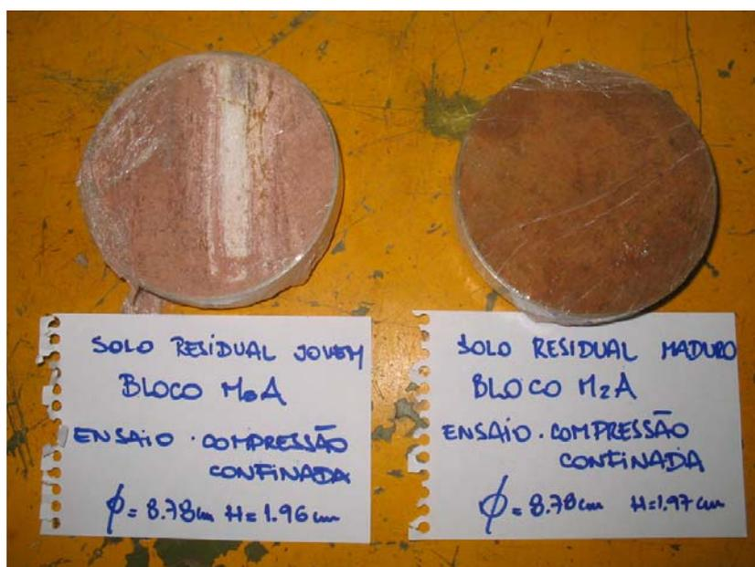
Figura 110. Corpos de prova dos ensaios de compressão confinada.
