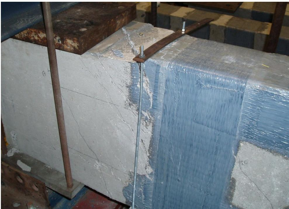
Figura B.36 – Detalhe da ruptura da viga VTL1 vista da esquerda.
