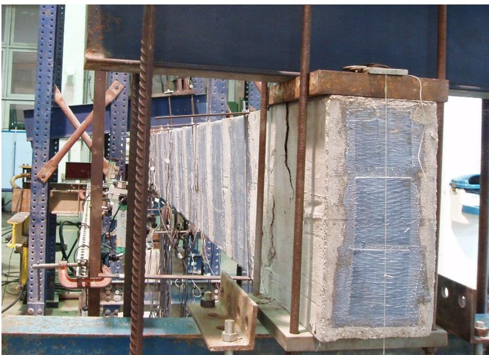
Figura B.21 – Detalhe da viga VT2 solicitada à torção.
