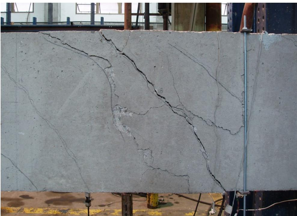
Figura B.8 – Detalhe da ruptura da viga VRef vista da face esquerda.
