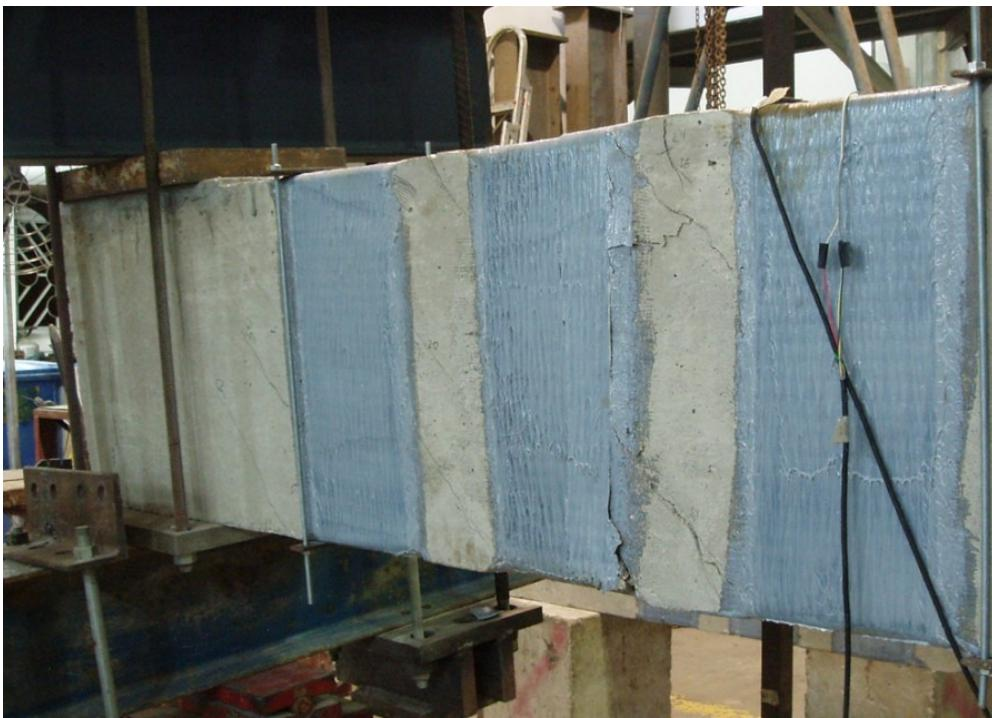
Figura B.15 – Detalhe da ruptura da viga VT1 vista da esquerda.
