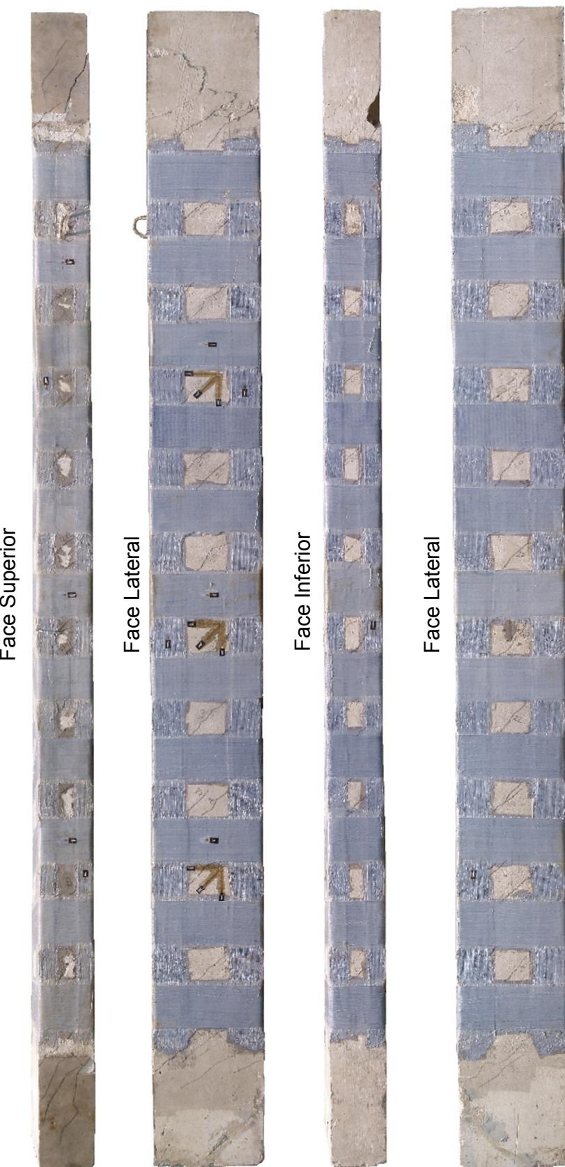
Figura B.45 – Configuração das fissuras da viga VTL2.
