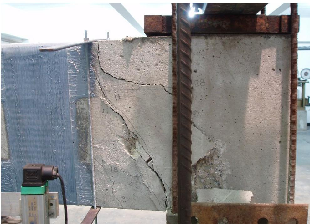
Figura B.35 – Detalhe da ruptura da viga VTL1 vista da direita.
