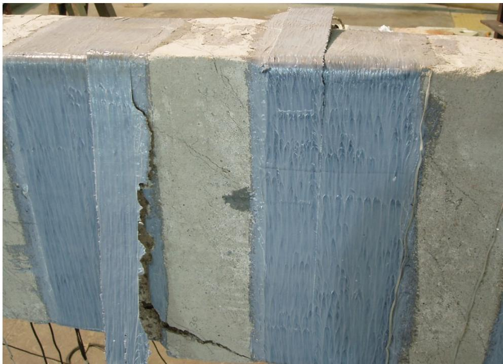
Figura B.29 – Detalhe da ruptura da viga VT3 vista da direita.
