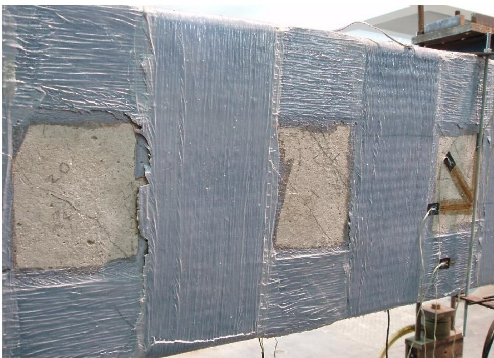
Figura B.43 – Detalhe do descolamento do CFC da viga VTL2 vista da direita.
