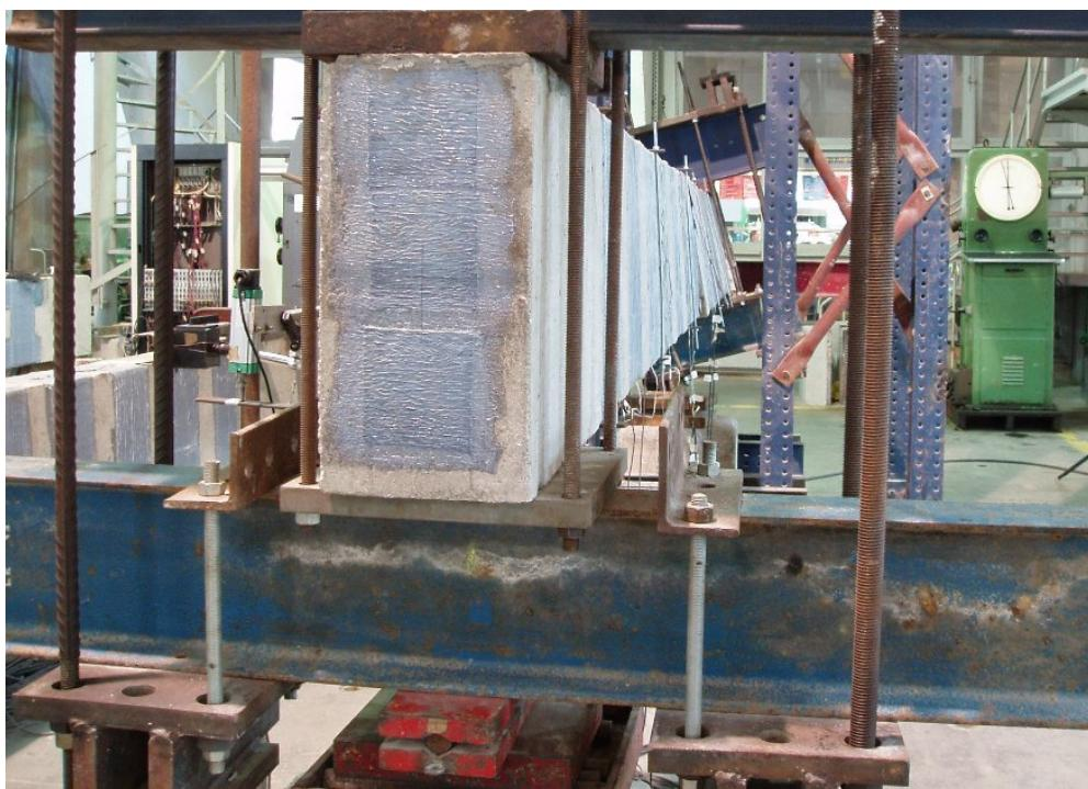
Figura B.27 – Detalhe da viga VT3 solicitada à torção.
