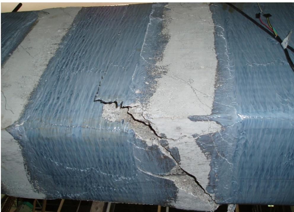
Figura B.16 – Detalhe da ruptura da viga VT1 vista da face inferior.
