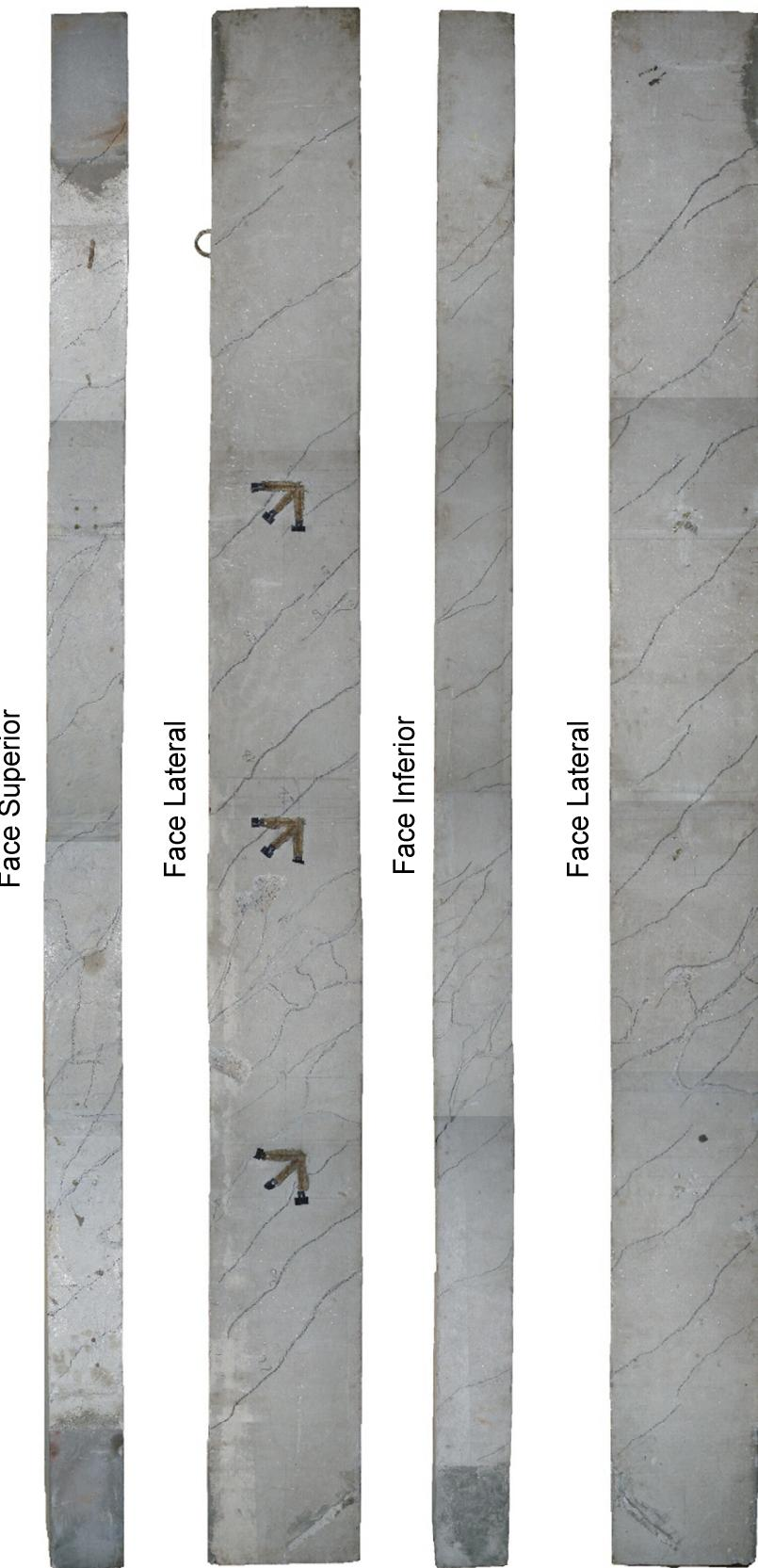
Figura B.10 – Configuração das fissuras da viga VRef.
