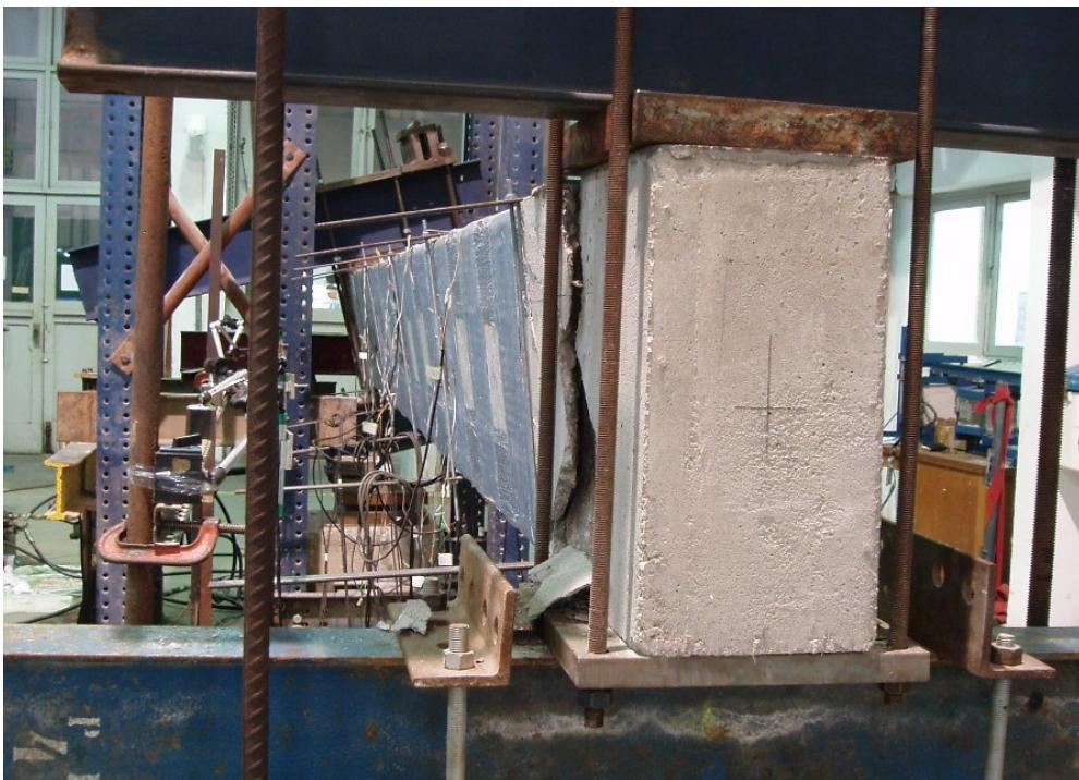
Figura B.34 – Detalhe da viga VTL1 solicitada à torção.
