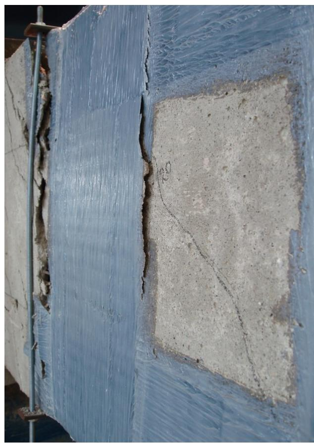
Figura B.37 – Detalhe do descolamento da CFC.
