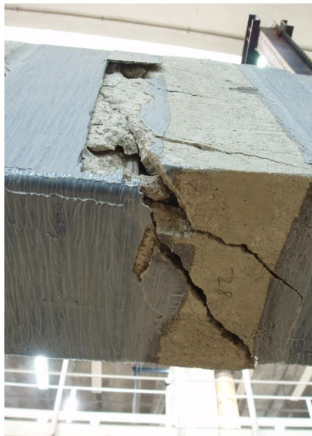
Figura B.30 – Detalhe da ruptura da viga VT3 vista inferior.
