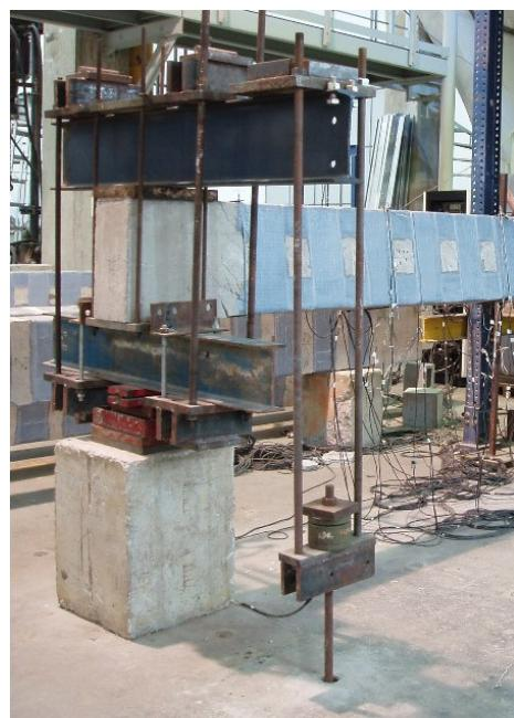
Figura B.2 – Elemento de reação.
