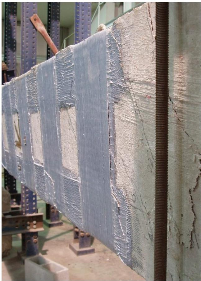
Figura B.44 – Detalhe do descolamento do CFC da viga VTL2 vista da esquerda.
