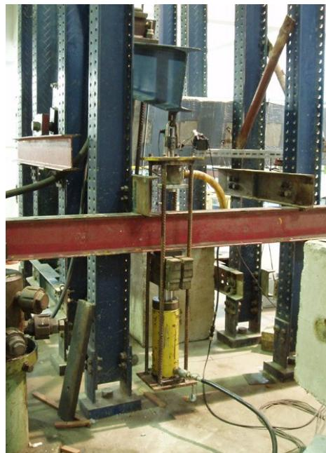
Figura B.1 – Aplicação da força.
