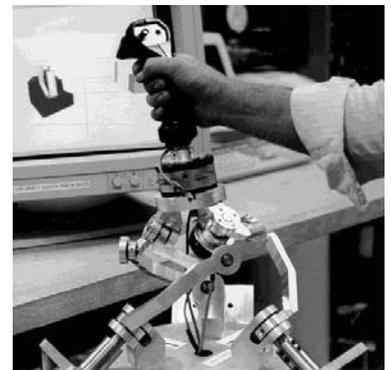
Figura 12 - *Force Feedback*: A ação do usuário é amplificada pela reação mecânica do dispositivo, simulando entre outras coisas, atrito sobre superfícies.
