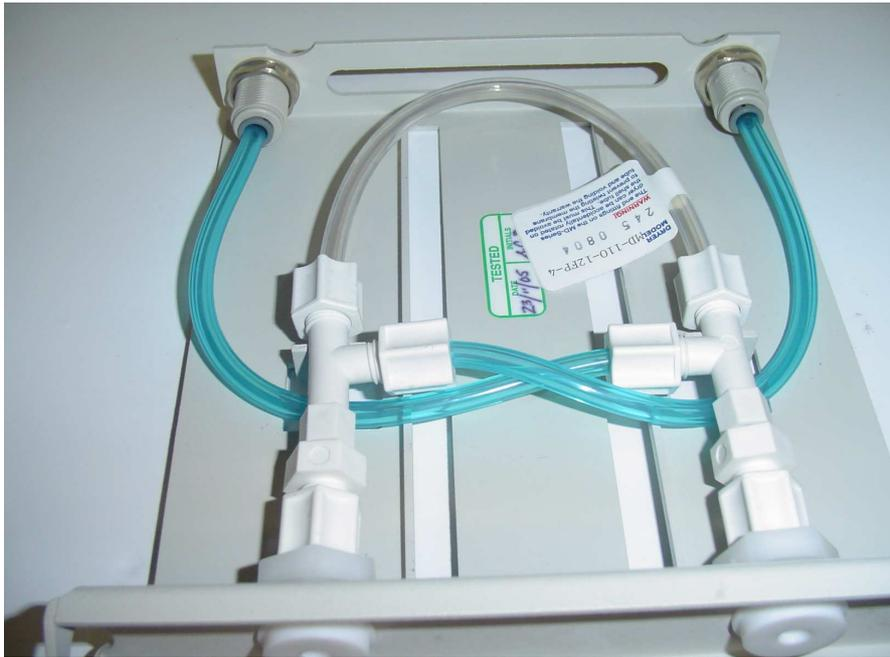
Figura 5. Membrana Perma Pure.
