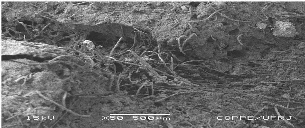
Figura 4.18 – Distribuição das fibras na superfície de fratura do CPB6SR .
