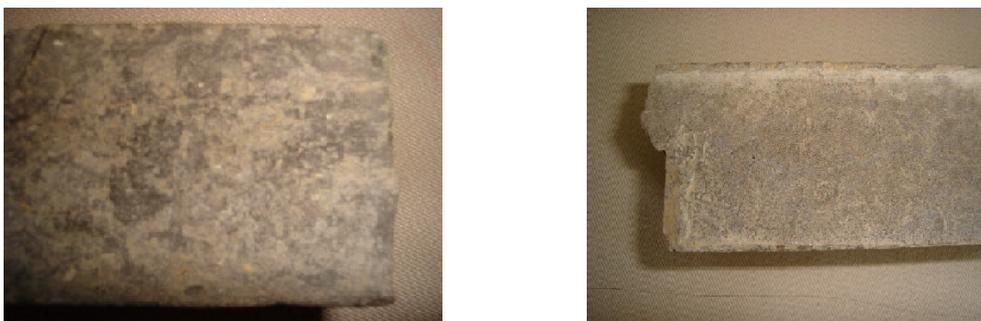
Figura 4.17 – Esquema apresentando a forma de propagação da trinca nos compósitos de 6% (à esquerda) e no 14%.
