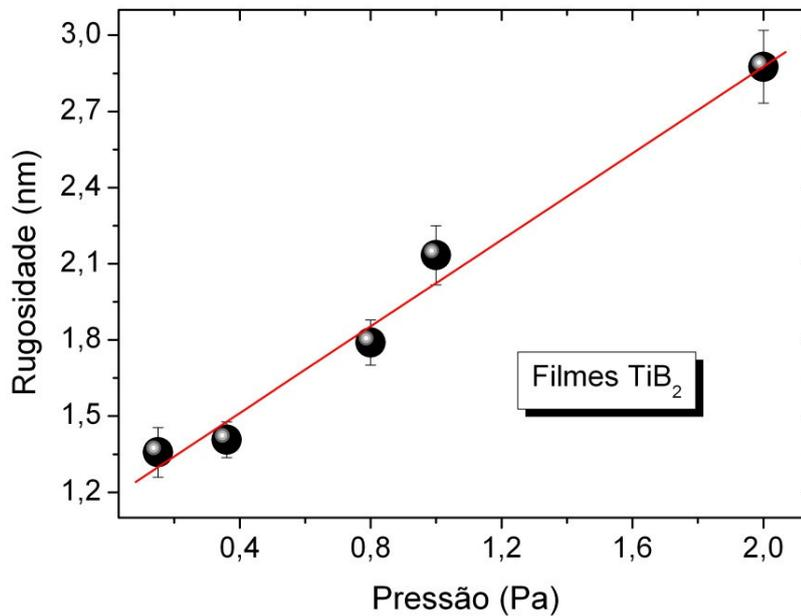
Figura 4.31 Rugosidade quadrática média de filmes de TiB<sub>2</sub> em função da pressão de deposição.
