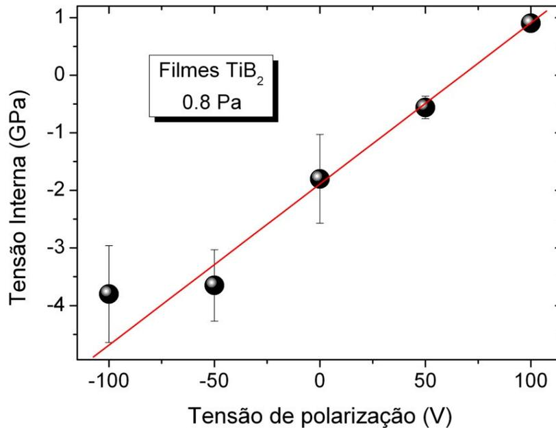
Figura 4.26 Tensão interna dos filmes de TiB<sub>2</sub> crescidos com diferente tensão de polarização
