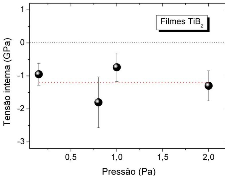
Figura 4.25 Tensão interna dos filmes de TiB<sub>2</sub> em função da pressão de deposição.
