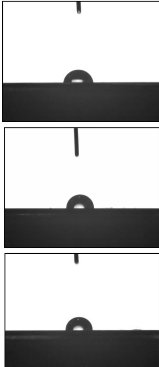
Figura 4.28 Imagens de três gotas de água sobre a superfície de filmes de  $TiB_2$  com pressões de 2Pa, 0.8Pa e 0.15Pa e ângulos de contato de  $79.7^\circ$ ,  $87.2^\circ$  e  $90.5^\circ$  respectivamente.
