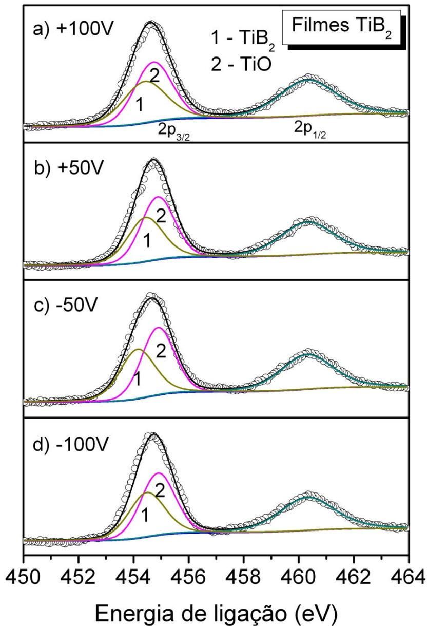
Figura 4.18 Espectros na região do titânio 2p para filmes de  $\text{TiB}_2$  com diferentes tensões de polarização aplicadas no substrato: a) +100V, b) +50V, c) -50V, d) -100V.
