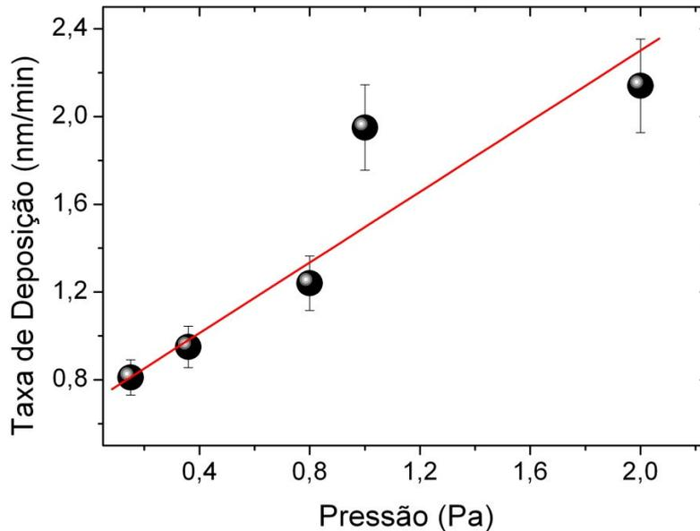
Figura 4.1 Variação da taxa de deposição em função da pressão no interior da câmara.
