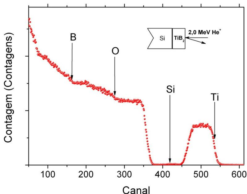
Figura 4.7 Espectro RBS de um filme de TiB<sub>2</sub> depositado numa atmosfera de argônio a pressão de 2,0Pa.
