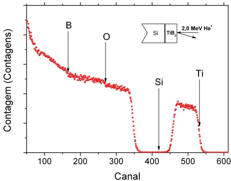
Figura 4.4 Espectro RBS de um filme de TiB<sub>2</sub> depositado numa atmosfera de argônio a pressão de 0,36Pa.
